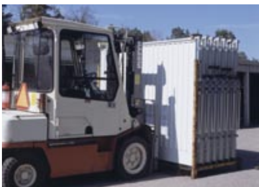
Portarna levereras helt förberedda med karm i ett enda stycke. Enkelt och säkert.
